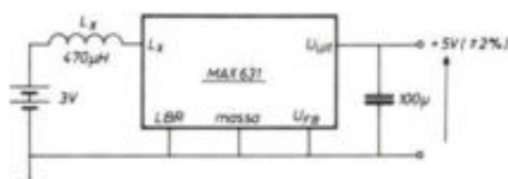
Fig. 10. De DC/DC-omzetter MAX631 met een van een batterij betrokken ingangsspanning van +3 V en een vaste uitgangsspanning van +5 V heeft slechts twee externe componenten nodig. Met dezelfde ingangsspanning en configuratie genereert de MAX632 een uitgangsspanning van +12 V en de MAX633 +15 V.
