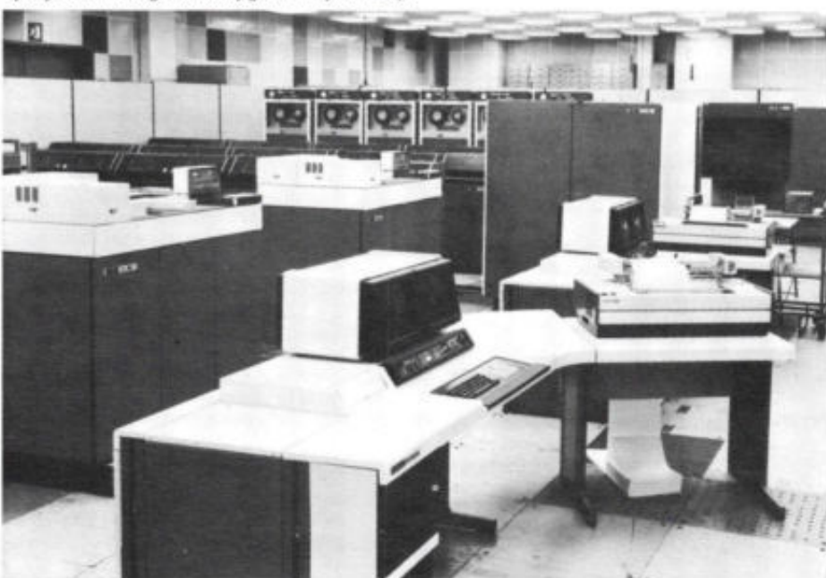
Afb. 10. De meeste werkstations worden in Oost-Europa gekoppeld aan mainframes. Deze mainframes zijn overwegend van wat oudere datum. Hier de Robotron EC1055M, waarvan de productie op dit moment afloopt. Toch zijn honderden van deze systemen in gebruik bij technologische bedrijven. Behalve als 'host' voor CAD/CAM-werkplekautomatisering, wordt een dergelijk systeem ook gebruikt bij gate-array-ontwerp.
