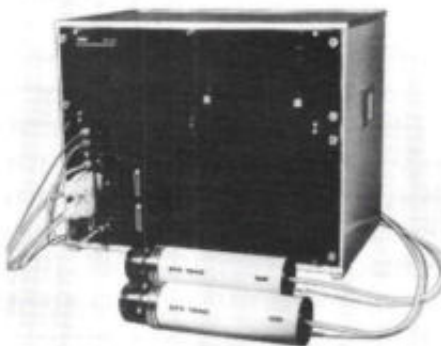
Afb. 2. Het beeldherkenningssysteem van Nachrichtenelektronik bestaat uit een eenheid van het type BEE1010 en een serie videocamera's, waarvan er hier twee van het type ZFK1040 zijn afgebeeld. Het totale systeem kreeg de type-aanduiding BES2000.
