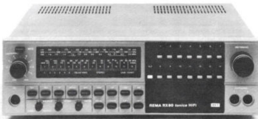
Afb. 5. Het compandersysteem UC van Radio und Fernsehen moet een kwaliteitsverbetering tot stand brengen voor de weergave van grammofoonplaten. RFT claimt een kwaliteit, die dichtbij de directe digitale weergave ligt.
