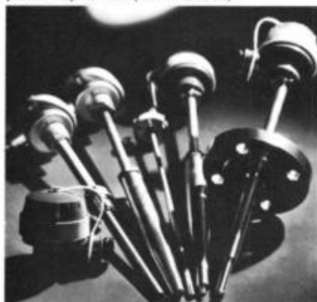
Afb. 15. Afhankelijk van de meetomgeving zijn er vele uitvoeringsvormen van industriële temperatuuropnemers (foto: Heraeus).
