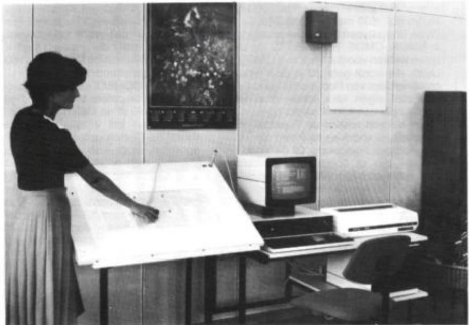
Afb. 9. Wat bij ons een PC is, moet in Oost-Europa veel meer als een individueel werkstation worden beschouwd. Dat is duidelijk te zien bij dit Robotron PC1715 systeem. Deze PC kunnen we in andere Oostblokstaten tegenkomen onder een ander typenummer, namelijk CM1904. Sedert begin dit jaar is dit systeem opgenomen in de eenheidsserie SKR en dat betekent buiten de DDR een andere type-aanduiding in het Oostblok.
