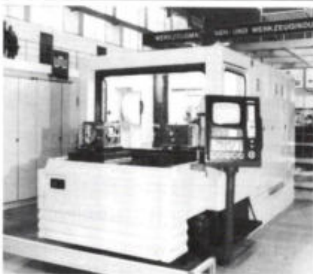
Afb. 7. Op deze foto een numeriek besturings-systeem van Automatiserings-anlagenbau, zoals gebruikt bij een bewerkingscentrum.
